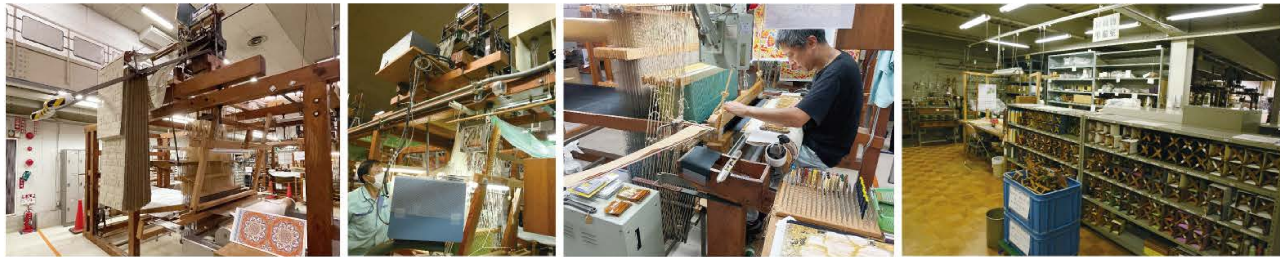
とところどころに、穴が空いた段ボールのようなものが「紋紙」と呼ばれるもの。これが、徐々にコンピュータの紋データへと進化しています。 ジャガードの説明をしてくださる佐々木さん。 何色もの緯糸を間違えないように、ときに、平らな箔を織り込みながら、手機で丸帯（袋帯の約二倍の幅）を織り進めていました。 糸繰りをしたり、枠に巻き取ったり、ポピンに巻いたり、整経をしたり……、染め上がった糸を機にかけるためには正確で丁寧な準備が必要です。
